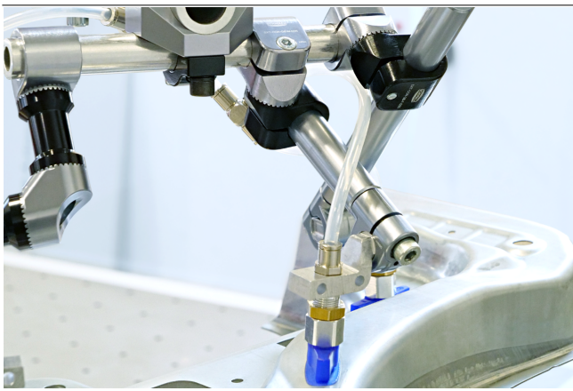
Winkelstück (verzahnt) SXT-ANG bei der Handhabung eines geformten Blechteils
